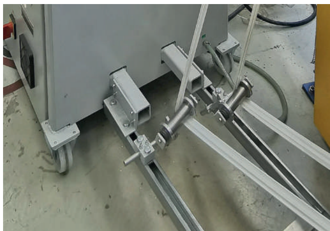
Чтобы обеспечить подачу обрезной кромки на уровне пола, фирма Getecha оснастила дробилки RS 2402 E дополнительными удлиняющими частями и направляющими роликами
