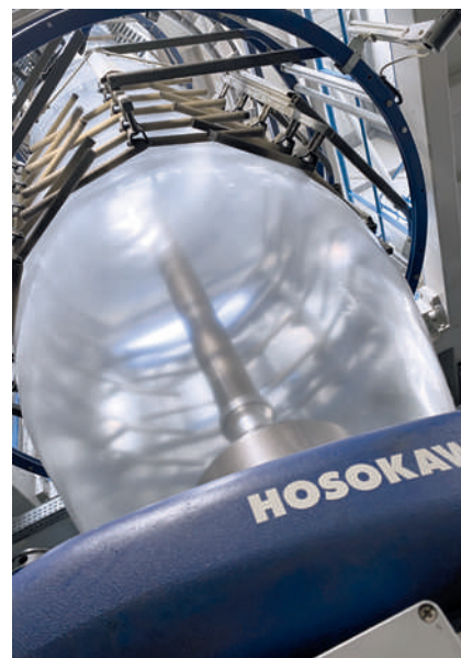
Линия Hosokawa Alpine на заводе ELA в польском городе Острув служит для выпуска пленок для ламинирования (фото: ELA)
