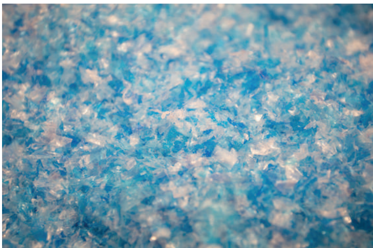
С помощью модуля EVO Ultra Fusion мелкие фракции (обрезки) пленки, а также различные производственные отходы и бывшие в употреблении полимеры самого низкого качества могут быть переработаны в функциональные пленки, используемые в пакетах для мусора или почтовых отправлений (фото: Reifenhäuser)
