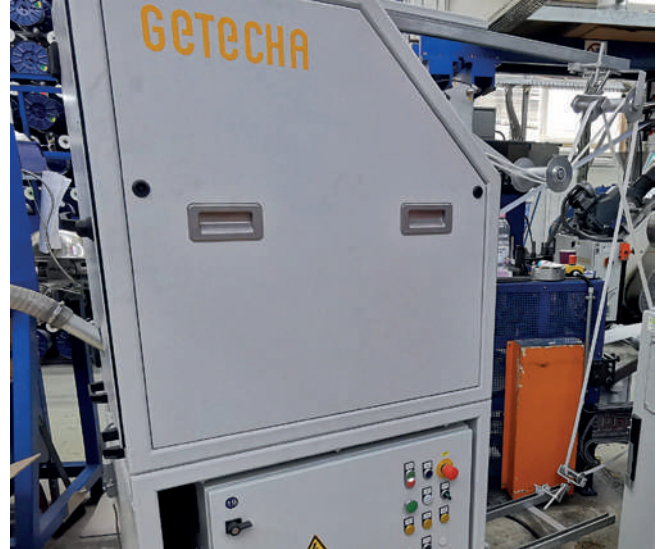
По желанию заказчика RS 2402 E от Getecha были заключены в корпус со звукоизоляцией, встроенным шкафом управления и колесиками. Передвижные блоки имеют компактную конструкцию
