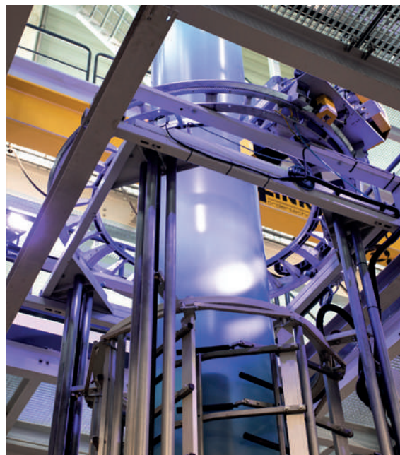
С помощью модуля EVO Ultra Fusion мелкие фракции (обрезки) пленки, а также различные производственные отходы и бывшие в употреблении полимеры самого низкого качества могут быть переработаны в функциональные пленки, используемые в пакетах для мусора или почтовых отправлений (фото: Reifenhäuser)
