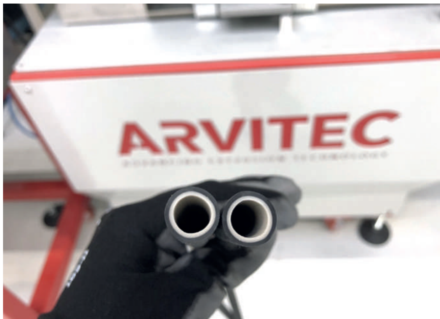
2-слойная труба, изготовленная на линии Arvitec
