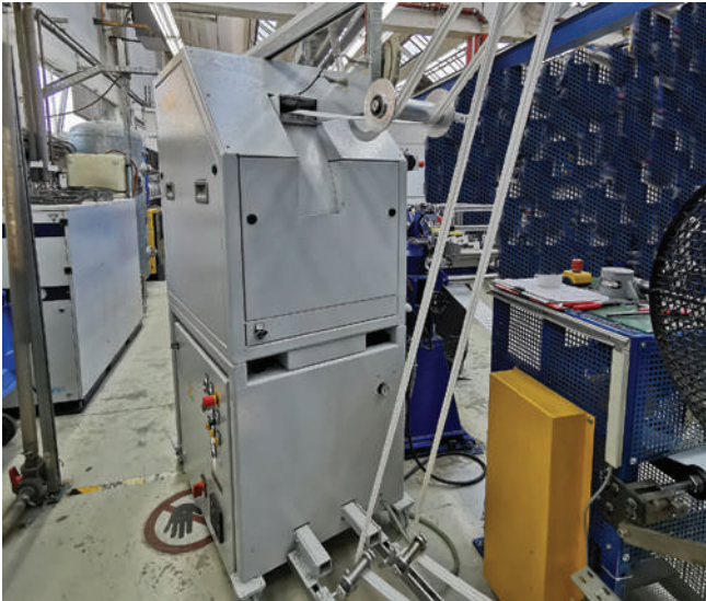
На экструзионной линии машина RS 2402 E от Getecha одновременно втягивает две кромочные ленты из термопластичного эластомера или полиуретана твердостью по Шору 50-95 А и дробит их, превращая в высококачественный измельченный материал (все фото: Getecha)
